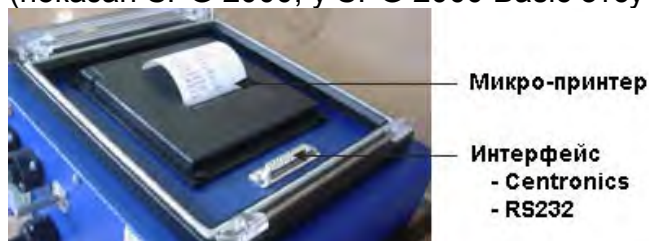
Рисунок 3.2: Вид сзади, разъемы (показан SPG 2000, у SPG 2000 Basic отсутствует микро-принтер)
