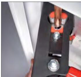
*Автоматический упор. Отличное позиционирование трубы на развальцовочном конусе*
