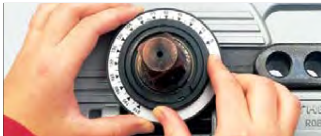
Предварительная установка угла гибки без использования инструмента
